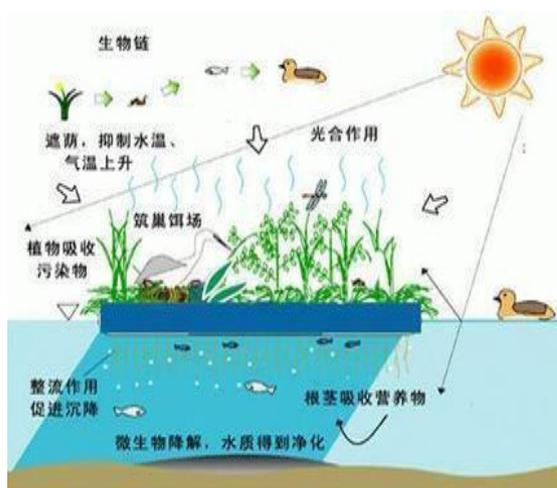
图 5.4-18 生态浮岛原理图
