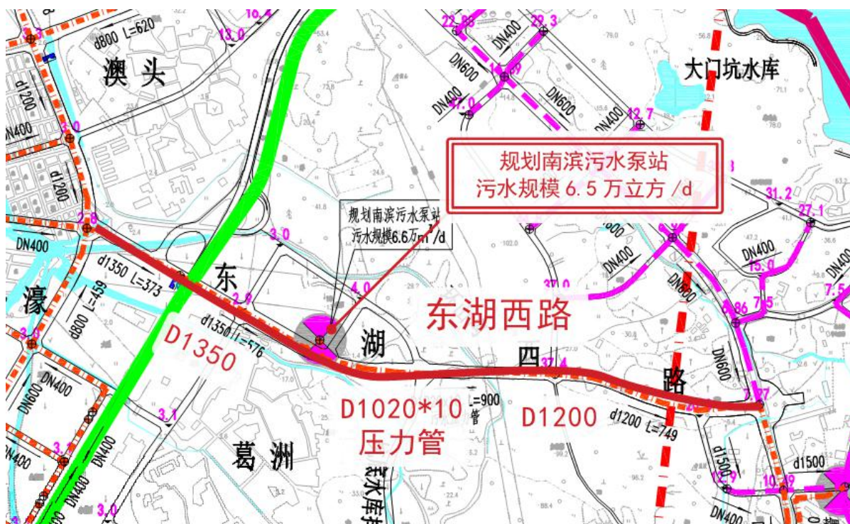
图 5-28 南滨污水提升泵站位置示意图
