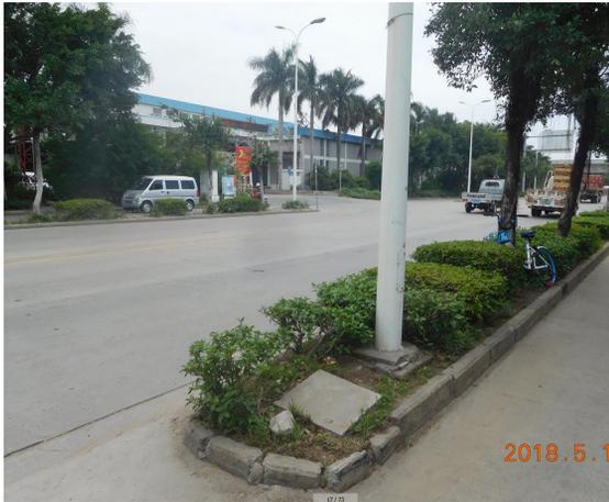
左图为汕樟北路（泰山路-下埠桥西）现状侧分带立缘石破损严重，本次设计侧分带立缘石全部更换。
