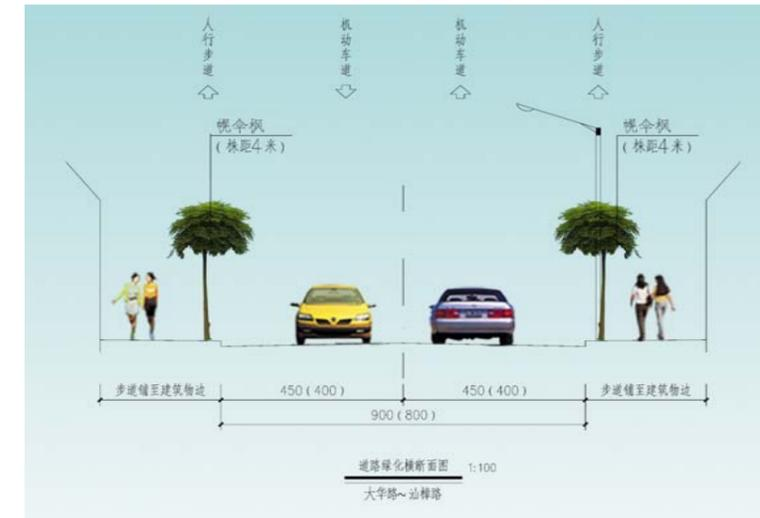
绿化标准横断面图示意图(大华路-汕樟路)
