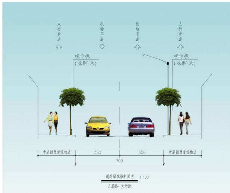
绿化标准横断面图示意图(月眉路-大华路)
