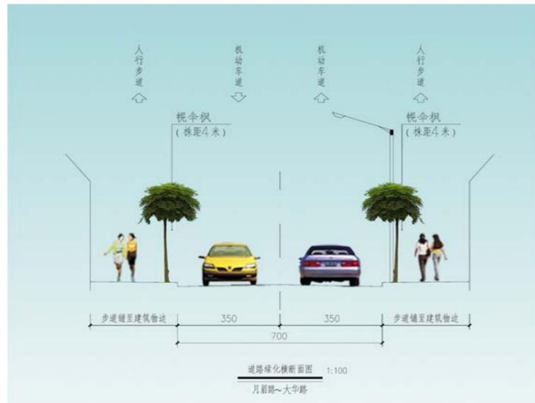
绿化标准横断面图示意图(月眉路-大华路)
