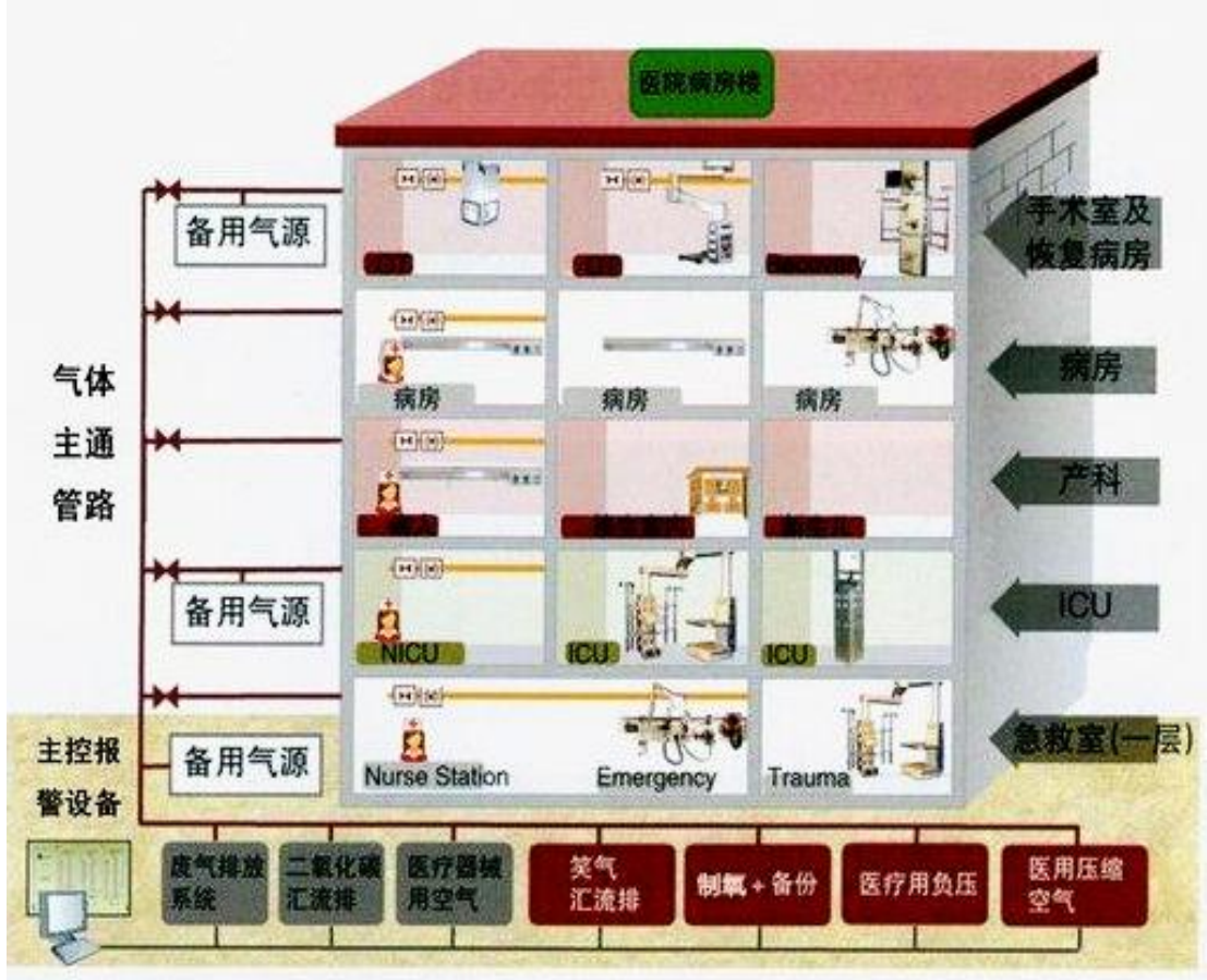
图 5-9 医用气体管道系统参考图
