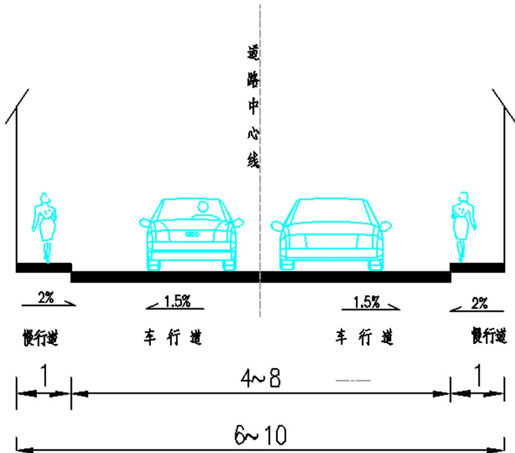
道路横断面组成及宽度维持现状, 其中七条改造后罩面的道路断面布置为: 标准具体设置为: 1.0m 慢行道 4~8m 车行道+1m 慢行道=6~8m (如下图示)。道路标准横断面布置维持现状, 横坡维持原来设计坡度。
