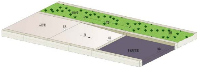
图 5.4-6 单面坡式残疾人坡道轴侧图
