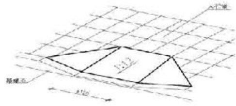
图 4 8：三面坡缘石坡道
