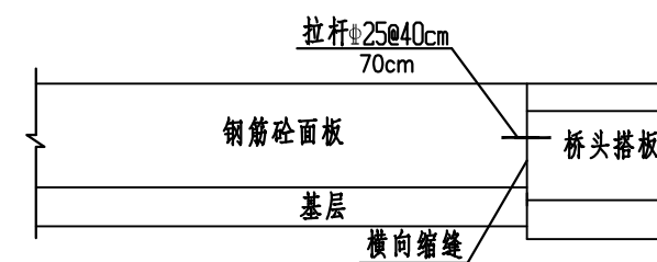
钢筋砼板及搭板相接的处理
