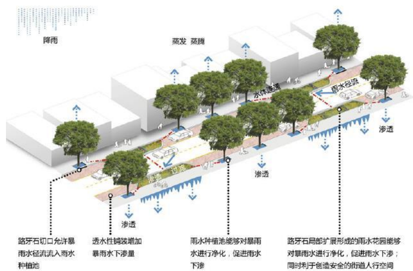
图 7.6-1 道路海绵系统流程
