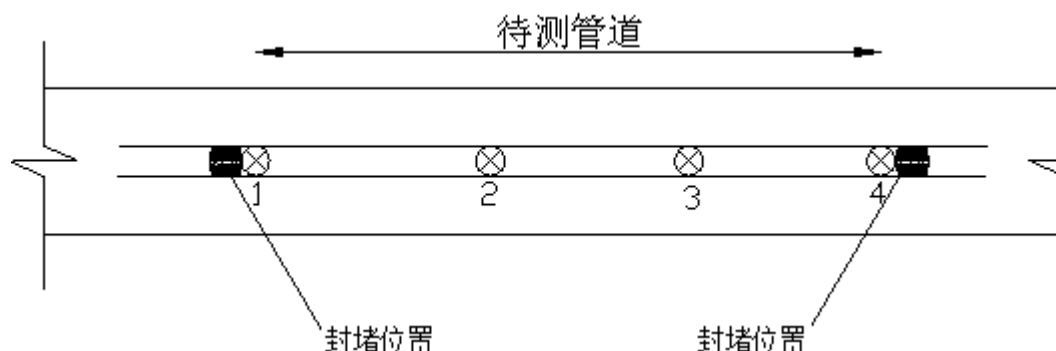
图 5.3-2 管道封堵示意图 1
