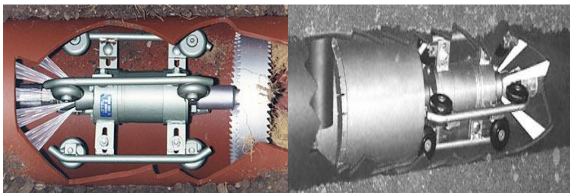
图 5.3-6 管内切割异物示意图
