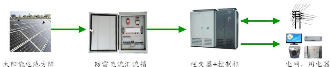
光伏并网系统原理示意图
