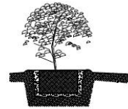
片植灌木、地被、时花种植详图 (种植时需脱袋种植) 种植穴=宽度(1.3倍土球)*深度(1.2倍土球)
