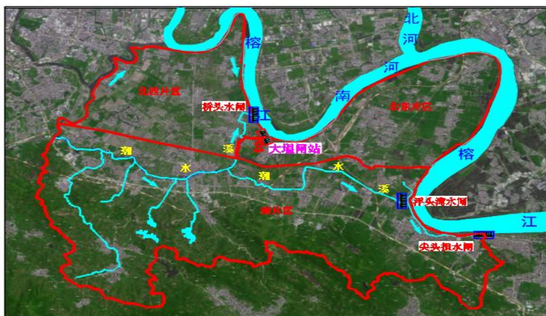
图 7.3-1 大塭水闸施工导流示意图
