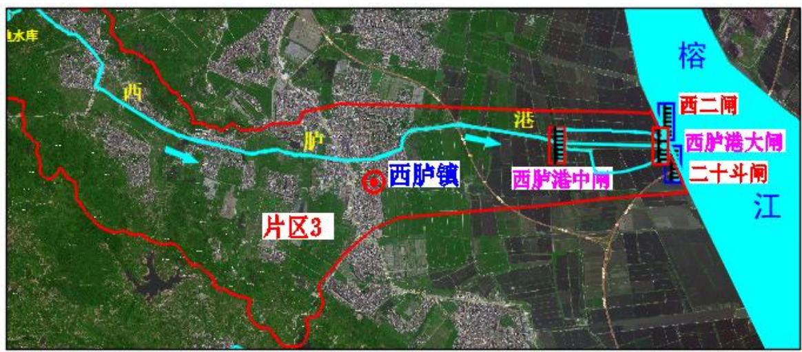
图 7.3-2 西水港中间施工导流示意图
