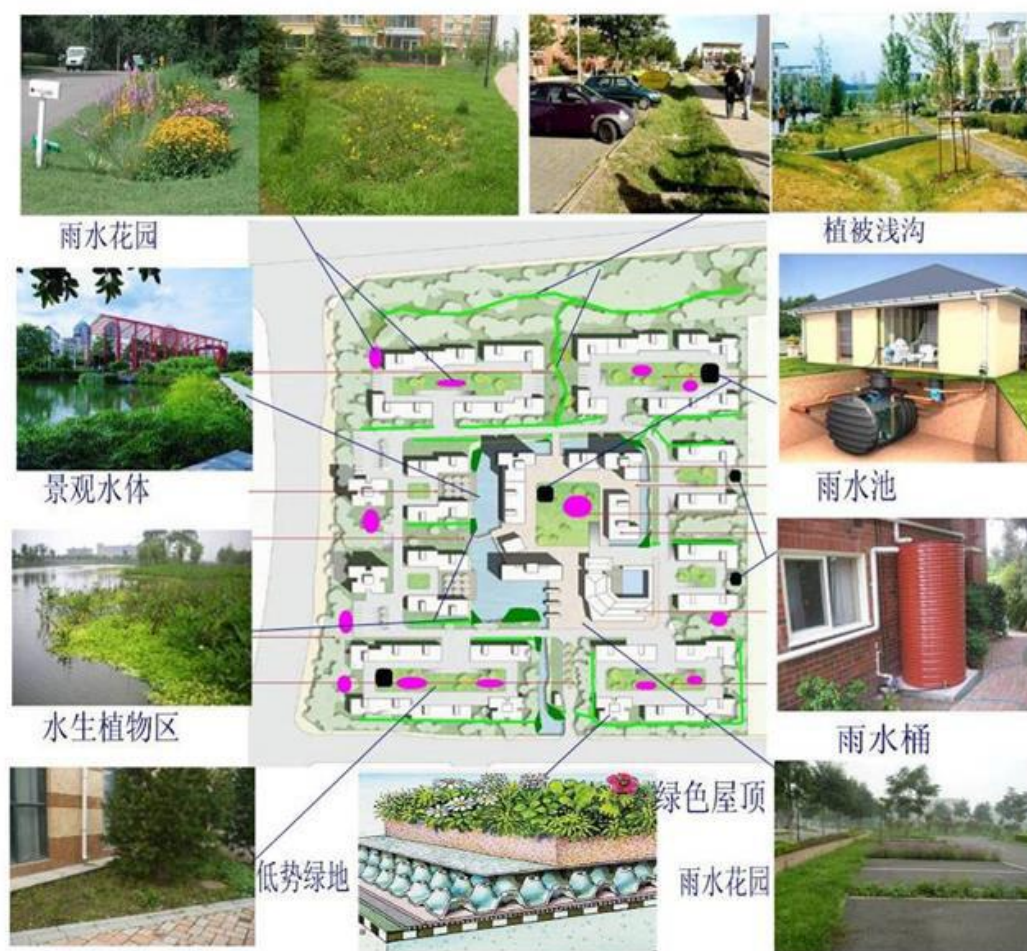
图 6-4 居住用地雨水的收集利用示意图
