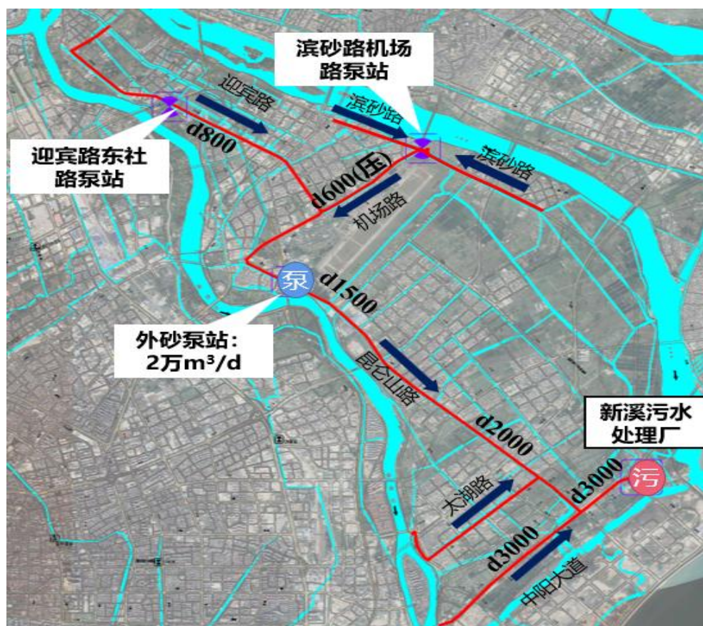
图 2.1-6 新溪污水处理厂（一期）污水系统主干管及泵站分布图
