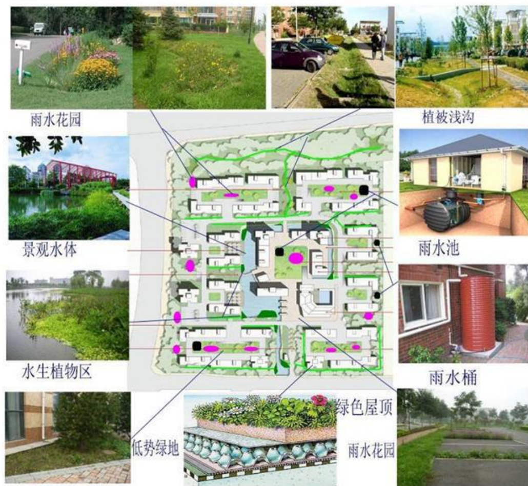
图 6-4 居住用地雨水的收集利用示意图
