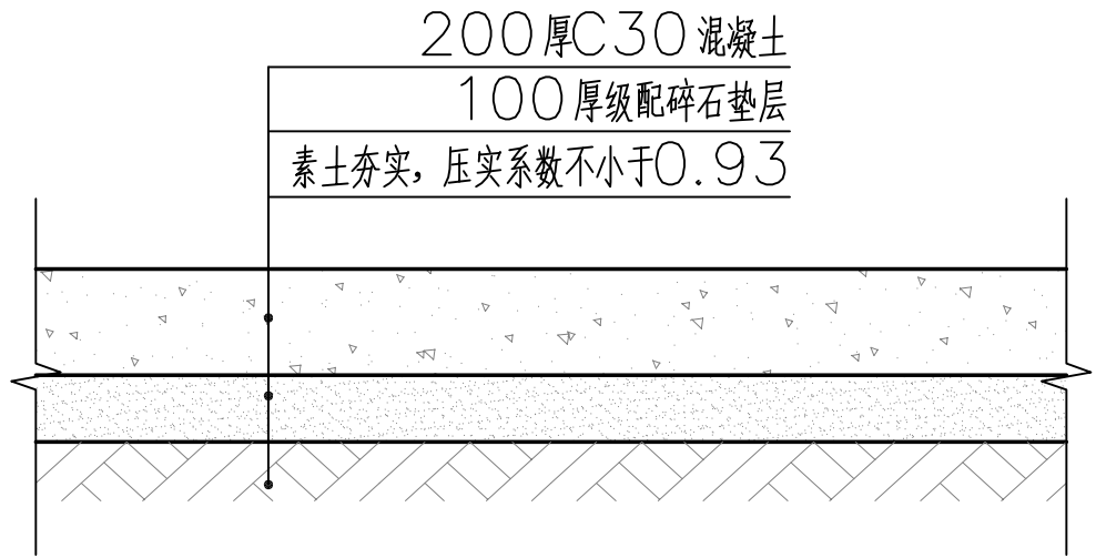
新建混凝土面层做法大样图
