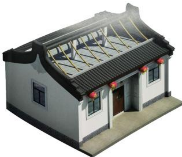
图 5.4-3 传统“厝角头+树脂瓦+装饰屋架”半坡屋面改造
