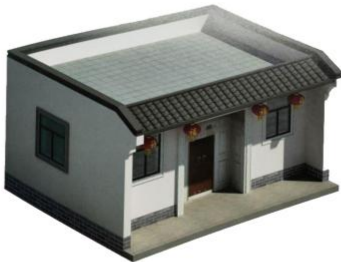
图 5.4-4 轻钢结构树脂瓦半坡悬挑屋面
