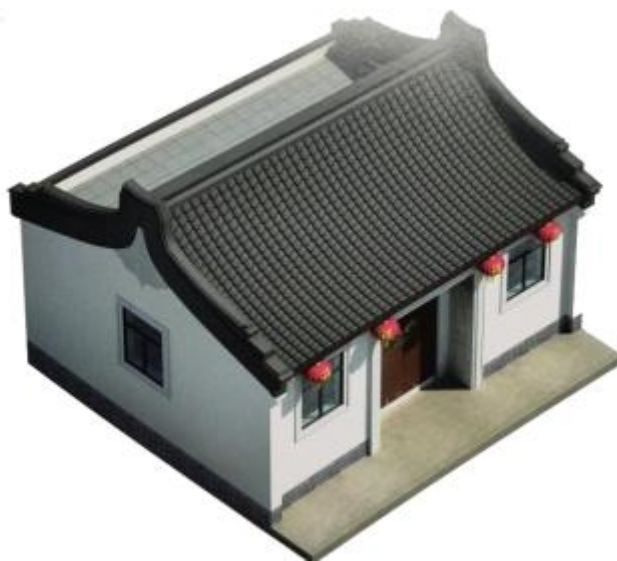
图 5.4-2 传统“厝角头+树脂瓦”单侧坡屋面
