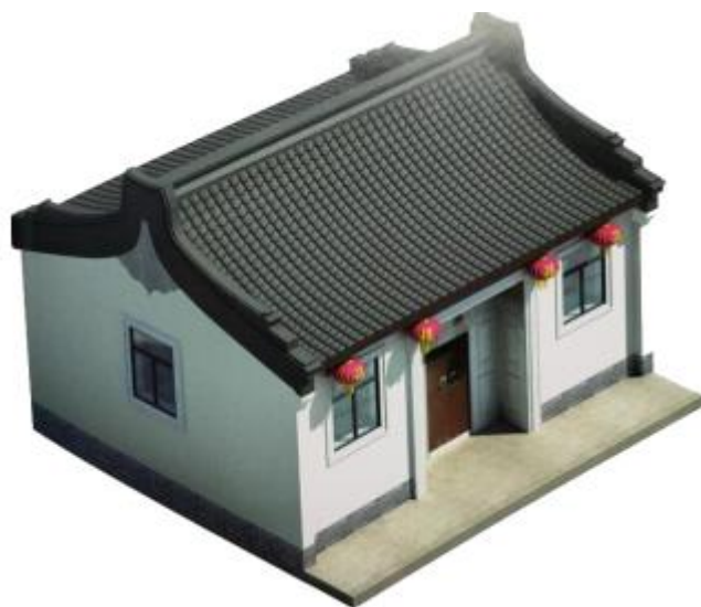
图 5.4-1 传统“厝角头+树脂瓦”全坡屋面
