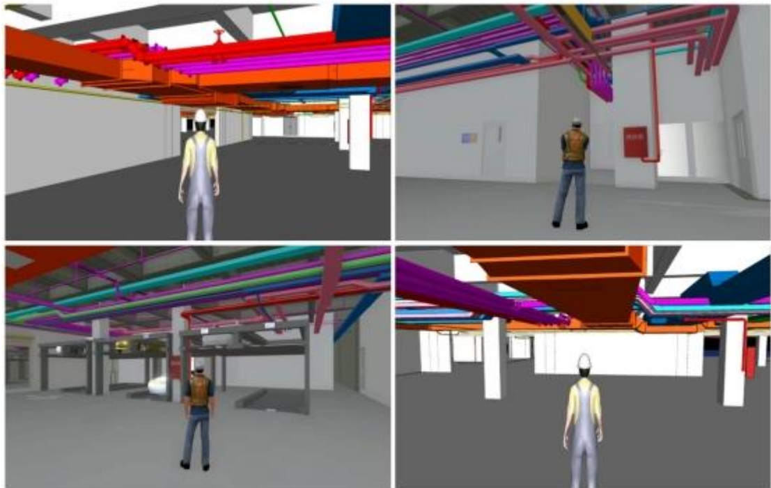
图 2.13-8 管综虚拟漫游模拟
