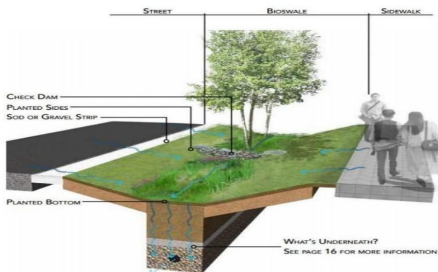
图 5.7 道路两侧生态植草沟示意图
