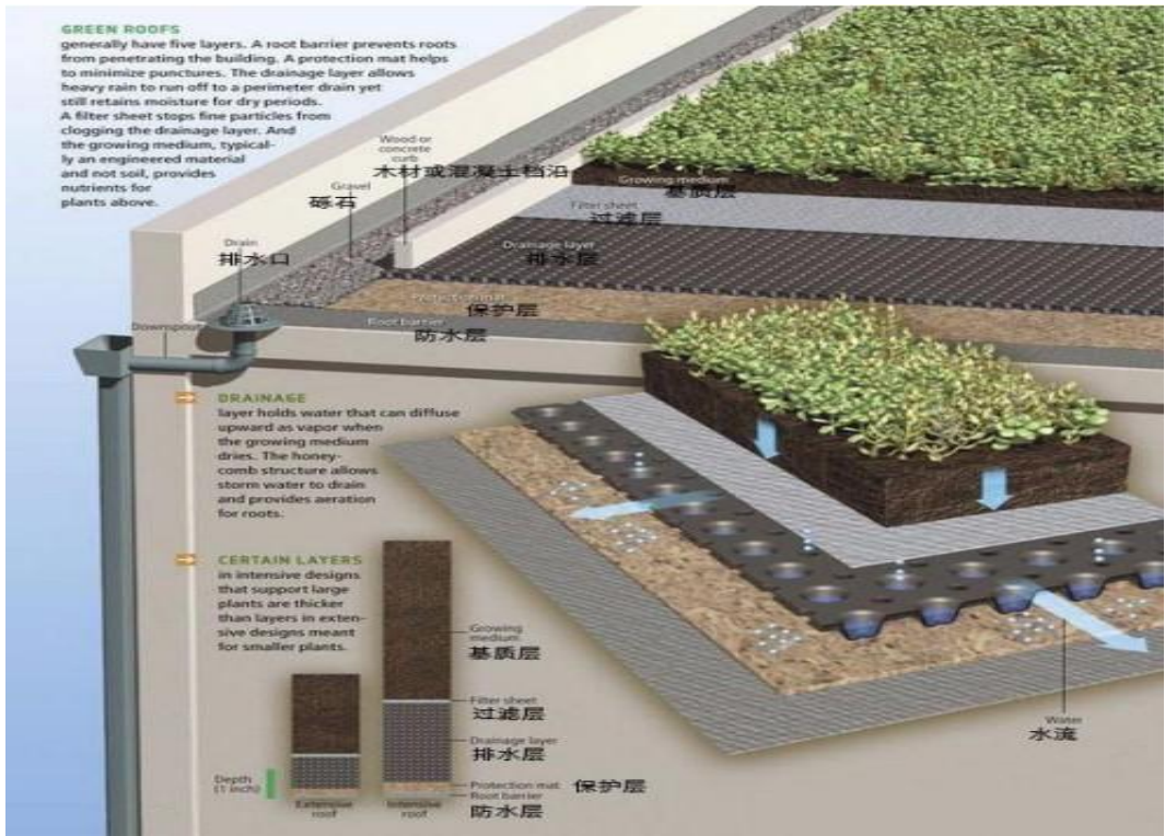
图 5.6 屋顶花园典型构造示意图
