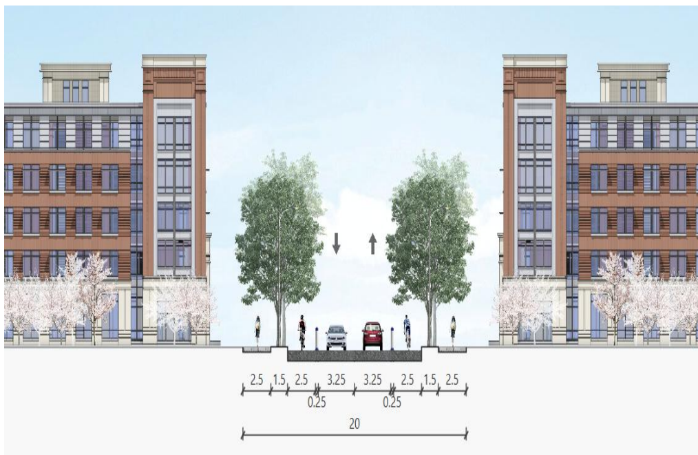
图 17 洛河路西延道路标准横断面图
