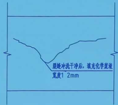
混凝土裂缝补大样图 (裂缝1~2mm)
