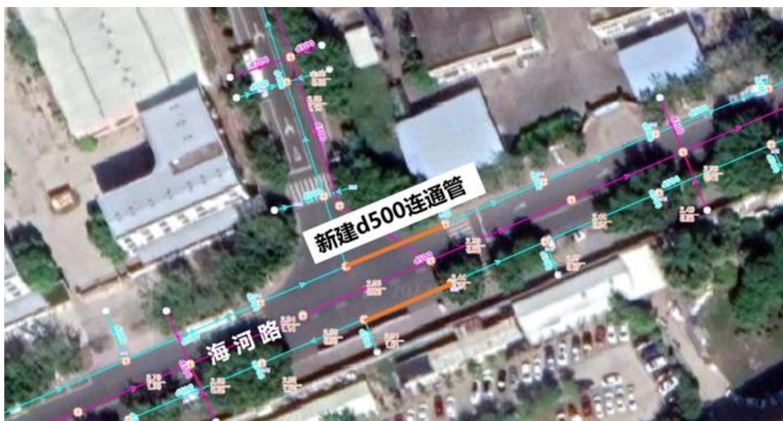
图 7.4-7 海河路新建 d500 连通管
