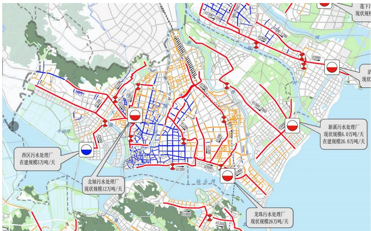
图 5.2-2 中心城区北岸现状污水及合流管网平面示意图
