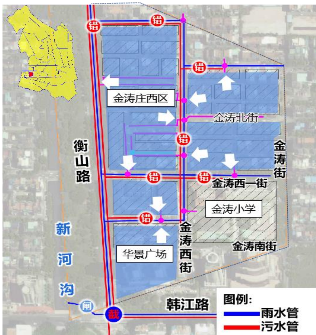
图 7.3-8 “金涛西街”排水分区管网完善方案平面图
