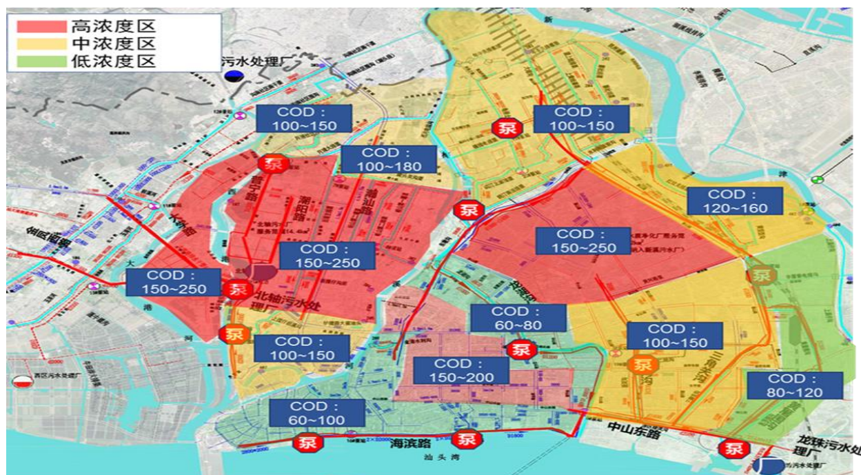
图 5.7-2 污水管水质浓度情况平面图
