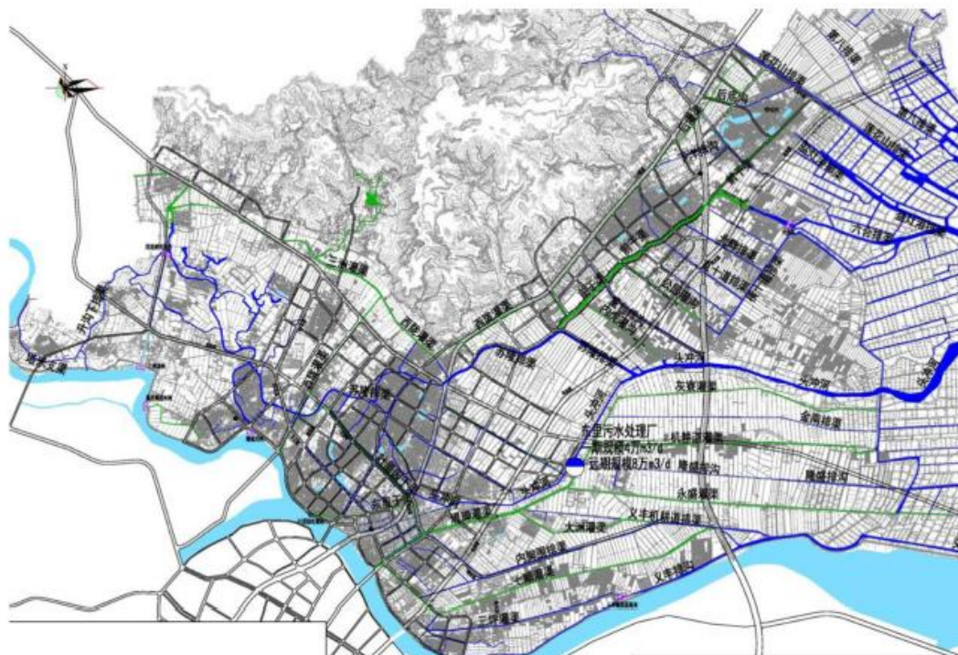
图 3-5 东里厂片区（隆都围）排水管网图
