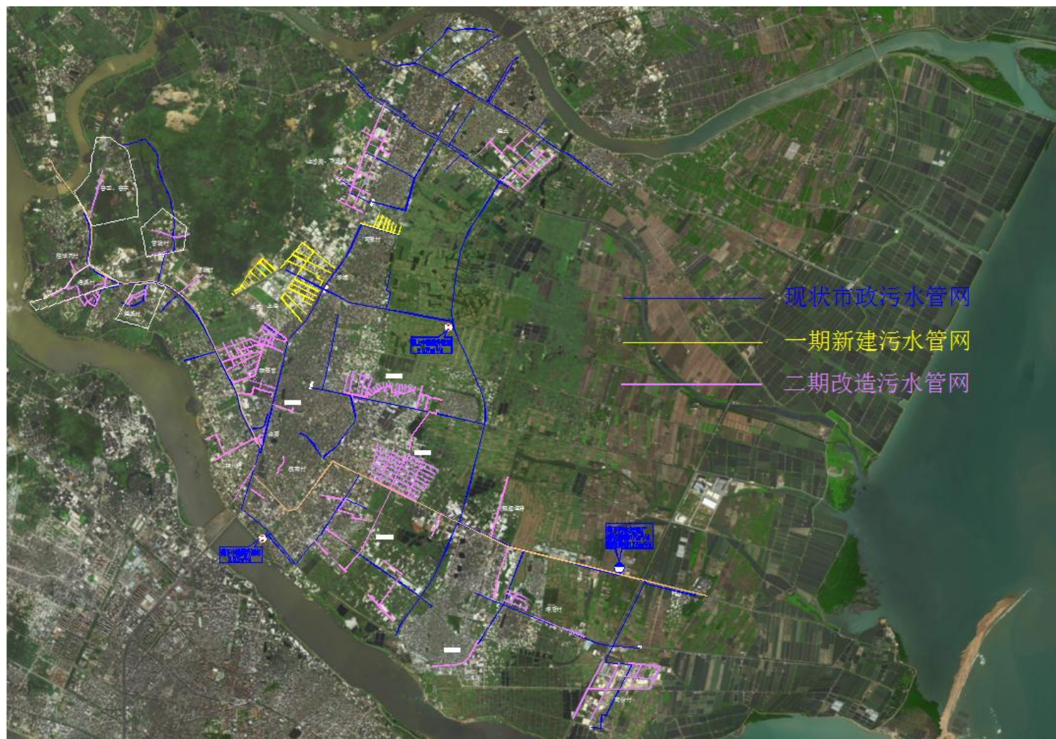
图 5-2 纳入莲下污水处理厂村庄污水管网建设方案图
