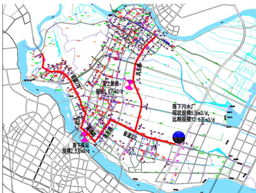
图 3-14 莲下污水处理厂收集管网总体方案图
